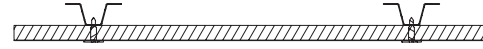
Instalación para muro, losa o I-Beam usando el enrasado o canaleta de acero (montaje D-20)
